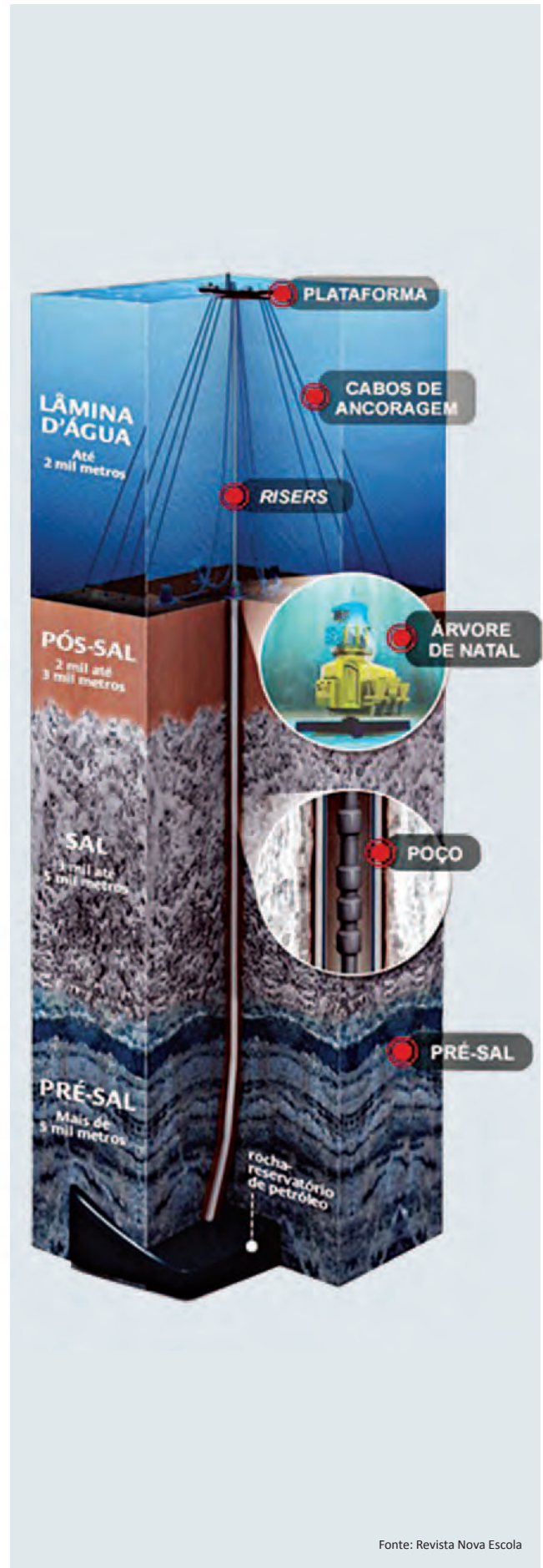
Figura 3 – Detalhe da interligação dos poços ao FPSO
