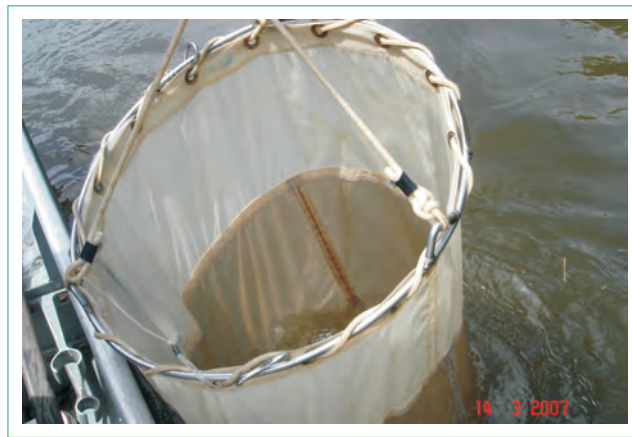
Lançamento de rede cilíndrico-cônica para coleta de zooplâncton
