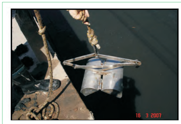
Lançamento do amostrador tipo Petersen utilizado para a coleta de sedimento.
