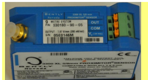
Módulo específico para sistema de monitoração de vibração - Proximitor Sensor Proximitor Sensor Fabricante: Bently Nevada Part Number: 330180-91-00 Modelo: 3300 XL Opção de montagem: em trilho DIN Comprimento do sistema: até 9 metros NM: 11.221.825
