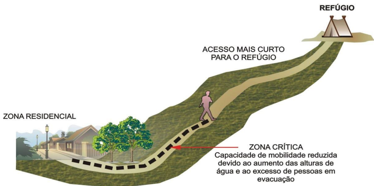
Figura 25 - Acesso a refúgios. Identificação de zonas críticas.
