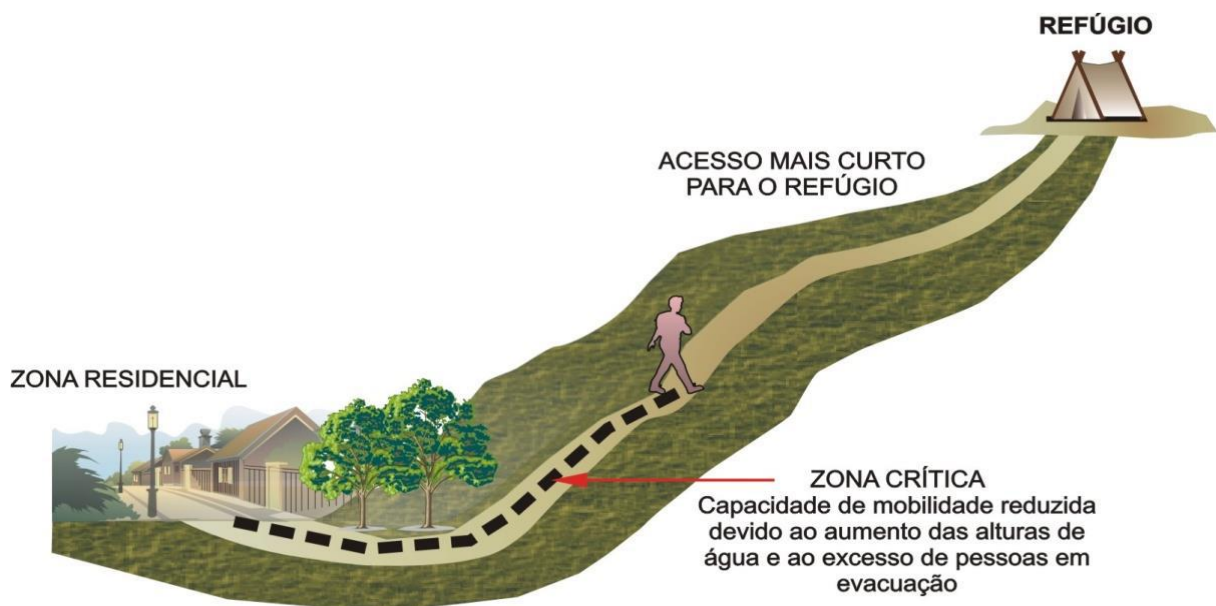
Figura 25 - Acesso a refúgios. Identificação de zonas críticas.
