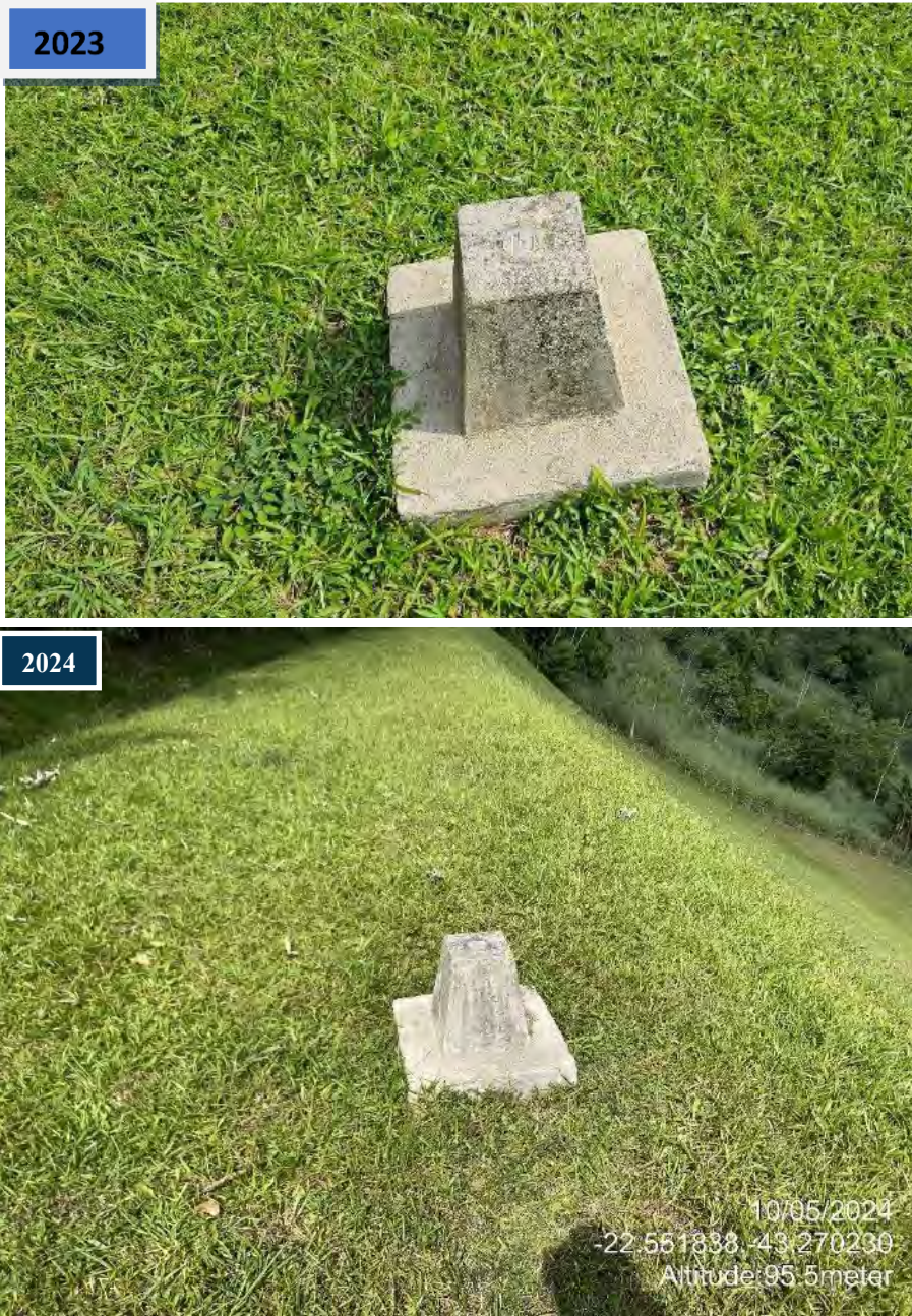
Figura 25: Comparativo marco de referência sem dispositivo de fixação durante as inspeções de 2023 e 2024.
