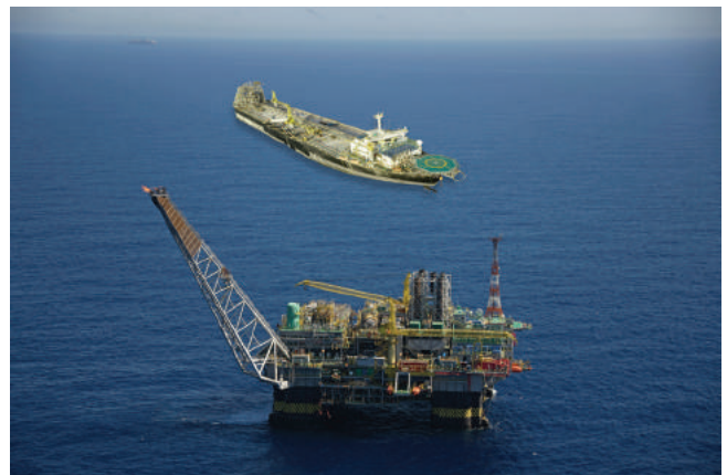
Plataforma tipo semissubmersível (SS) e Plataforma tipo FSO ( Floating, Storage and Offloading ). Fonte: Adaptado do Banco de Imagens da Petrobras.
