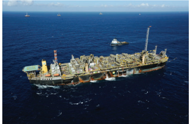
Plataforma tipo FPSO ( Floating, Production, Storage and Offloading ). Fonte: Banco de Imagens da Petrobras.
